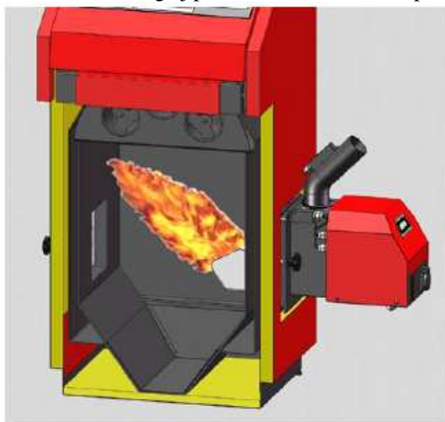
Lungimea flăcării – se termină cu 1 -3 cm înaintea de peretele opus al cazanului
